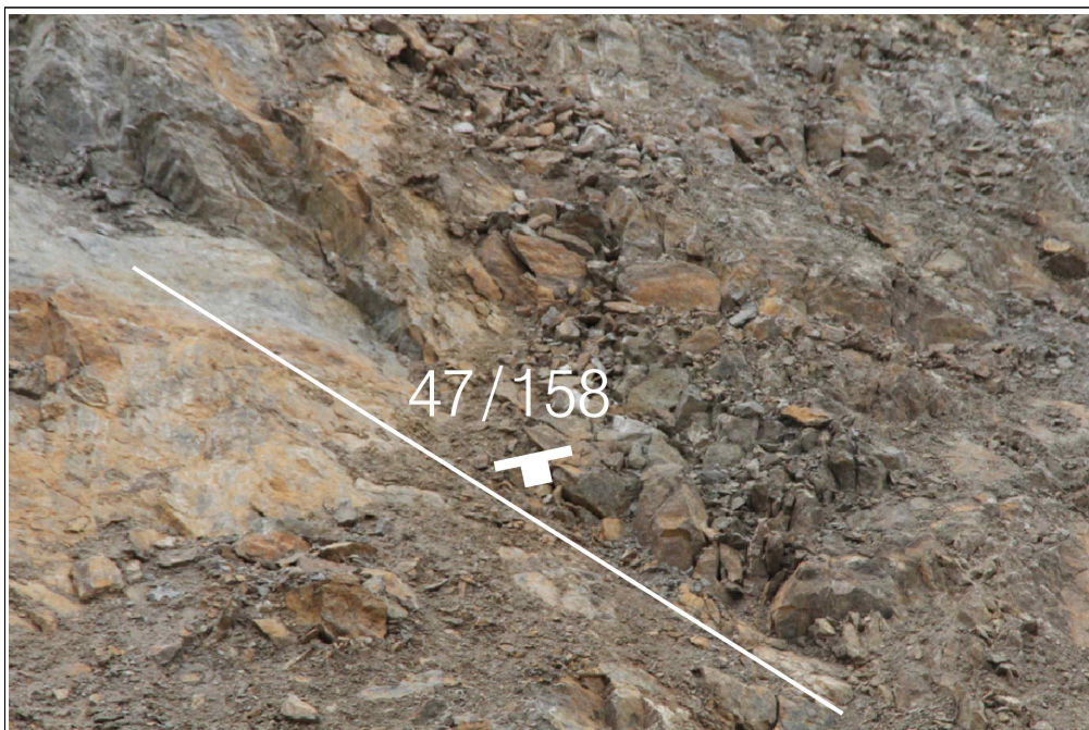
【그림 44】 E 영역에 발달한 불연속면
