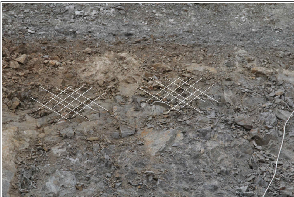
【그림 29】 C 영역 상세사진 (세편화된 암석)
