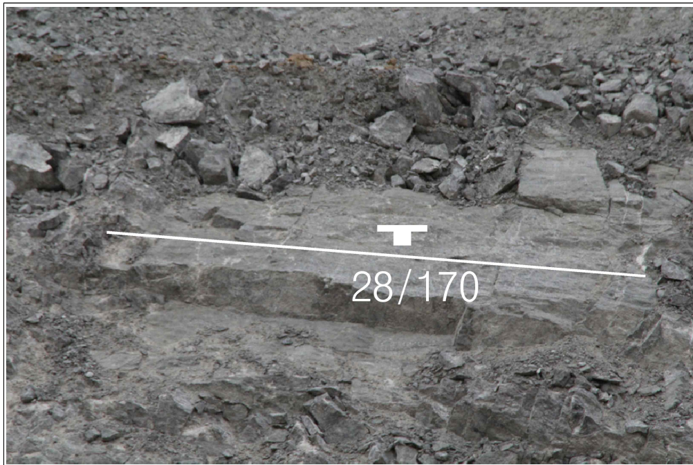
【그림 34】 D 영역에 발달한 불연속면
