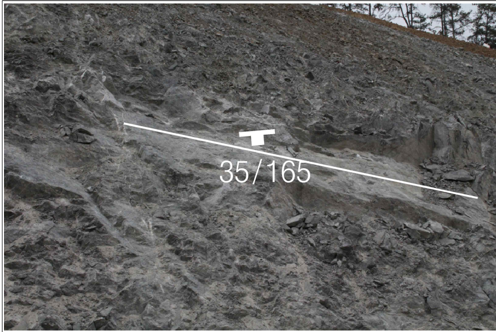
【그림 45】 E 영역에 발달한 불연속면
