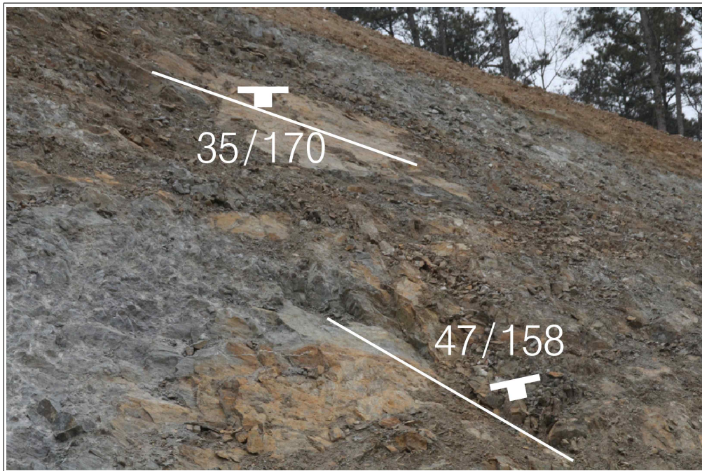
【그림 41】 E 영역에 발달한 불연속면
