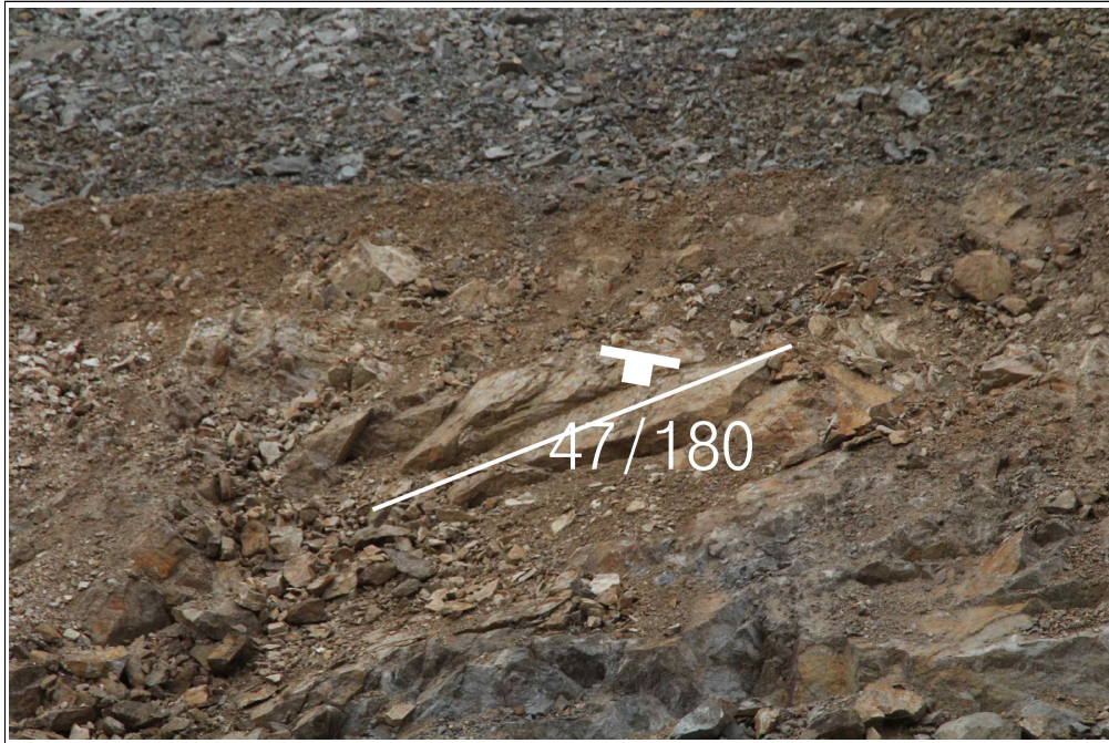
【그림 24】 C 영역에 발달한 불연속면
