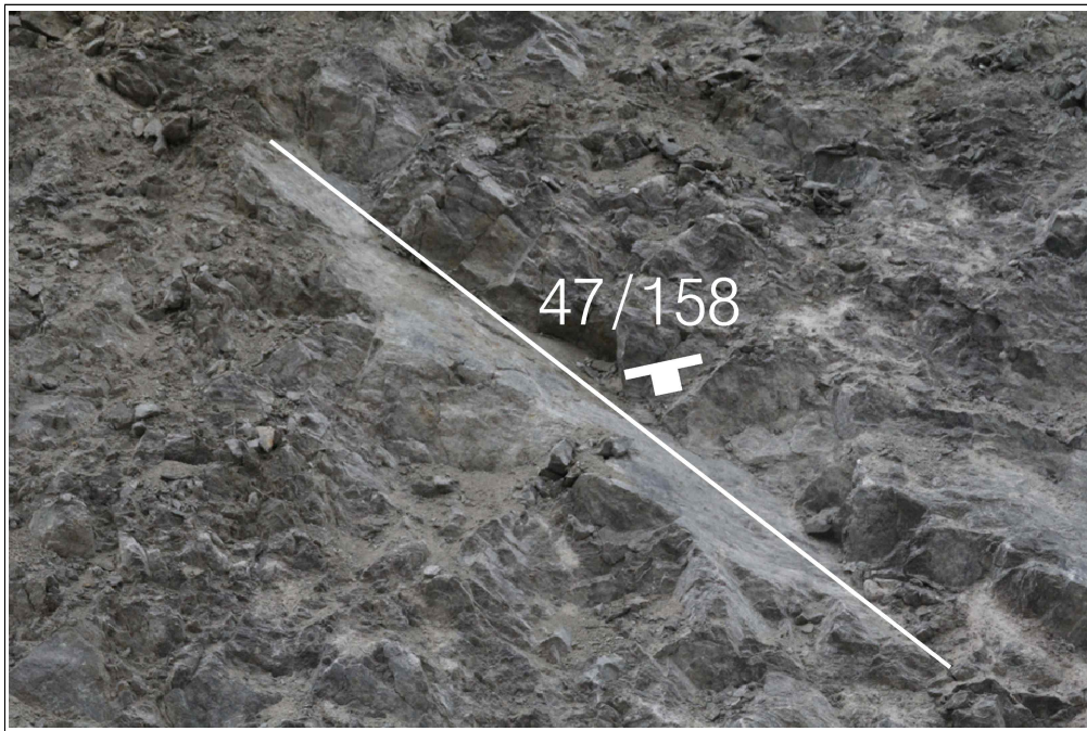
【그림 43】 E 영역에 발달한 불연속면
