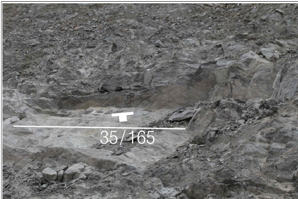
【그림 46】 E 영역에 발달한 불연속면
