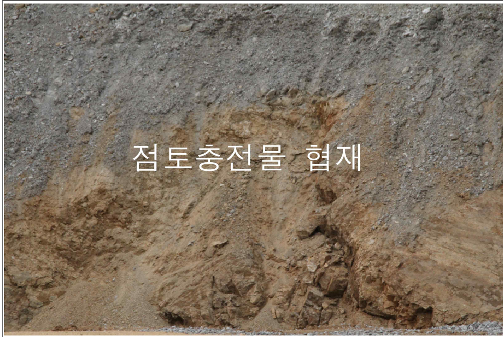
【그림 19】 B 영역 상세사진 (점토충전물 협재)
