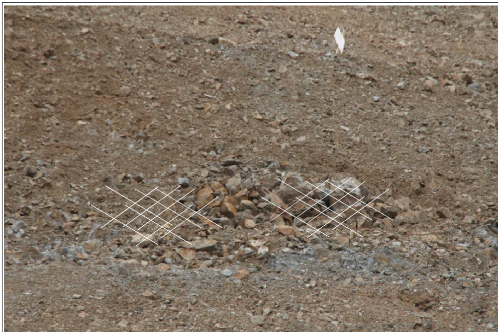
【그림 20】 B 영역 상세사진 (세편화된 암석)
